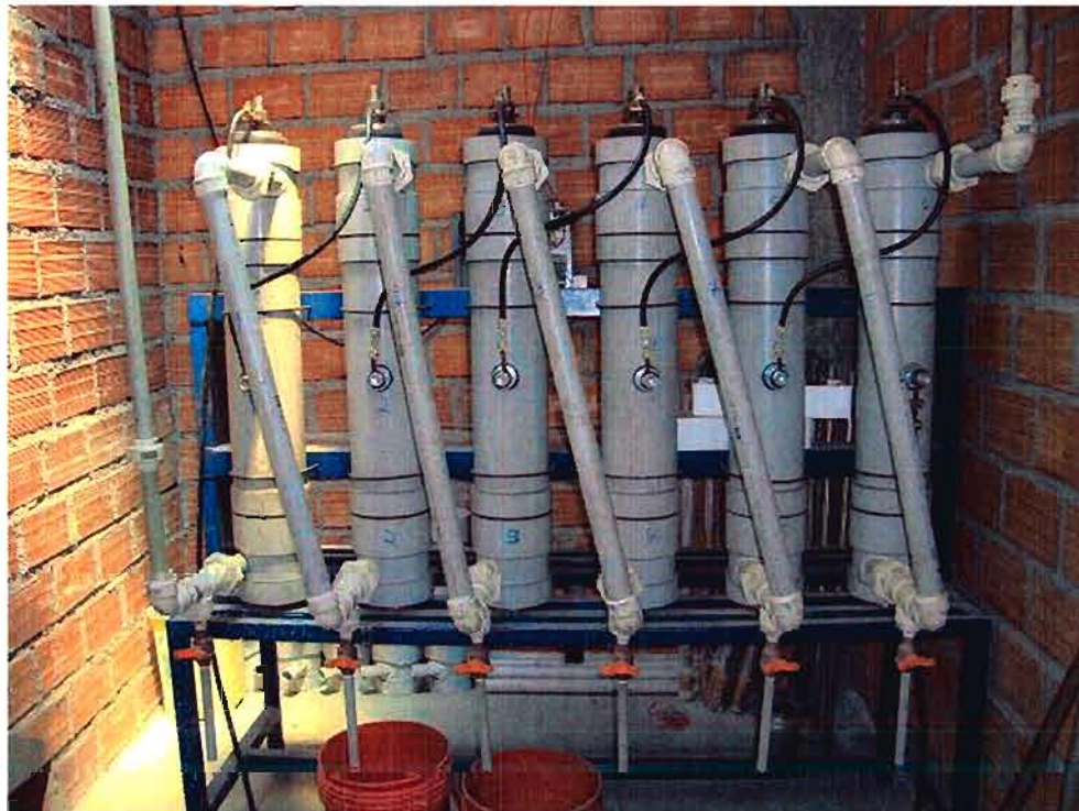
Fotografía 28. Celdas cilíndricas conectadas en serie.
