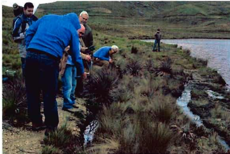
Fotografía 9. Control de pH, conductividad y temperatura en el agua de bofedales.
